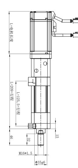
伺服电机部分根据 型号不同以及是否 增加减速机等尺寸 有所不同
