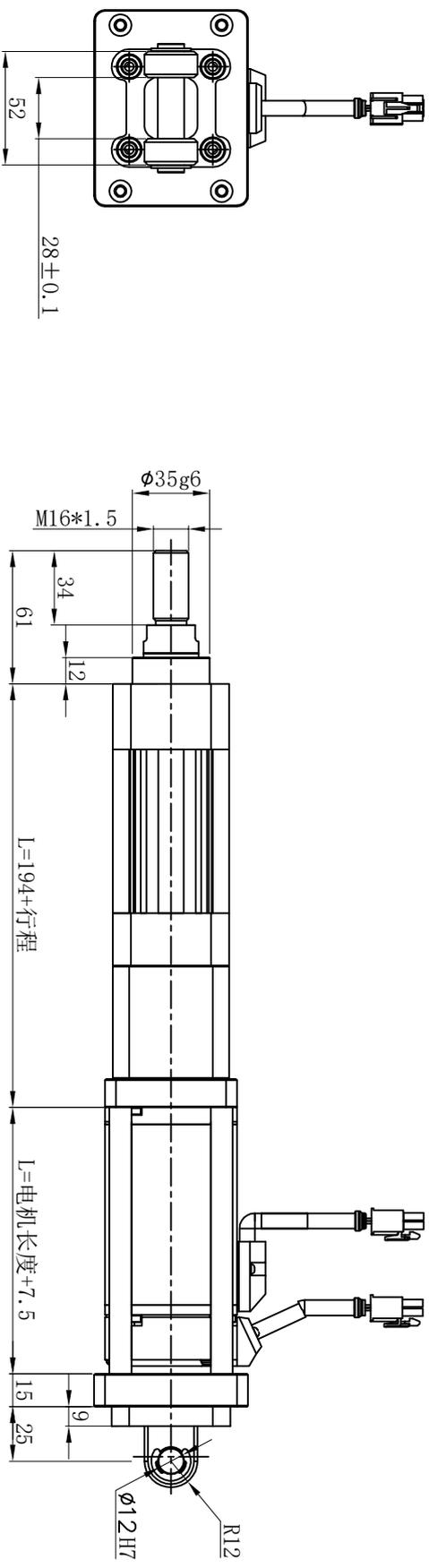
伺服电机部分根据型号不同以及是否增加减速机等尺寸有所不同
